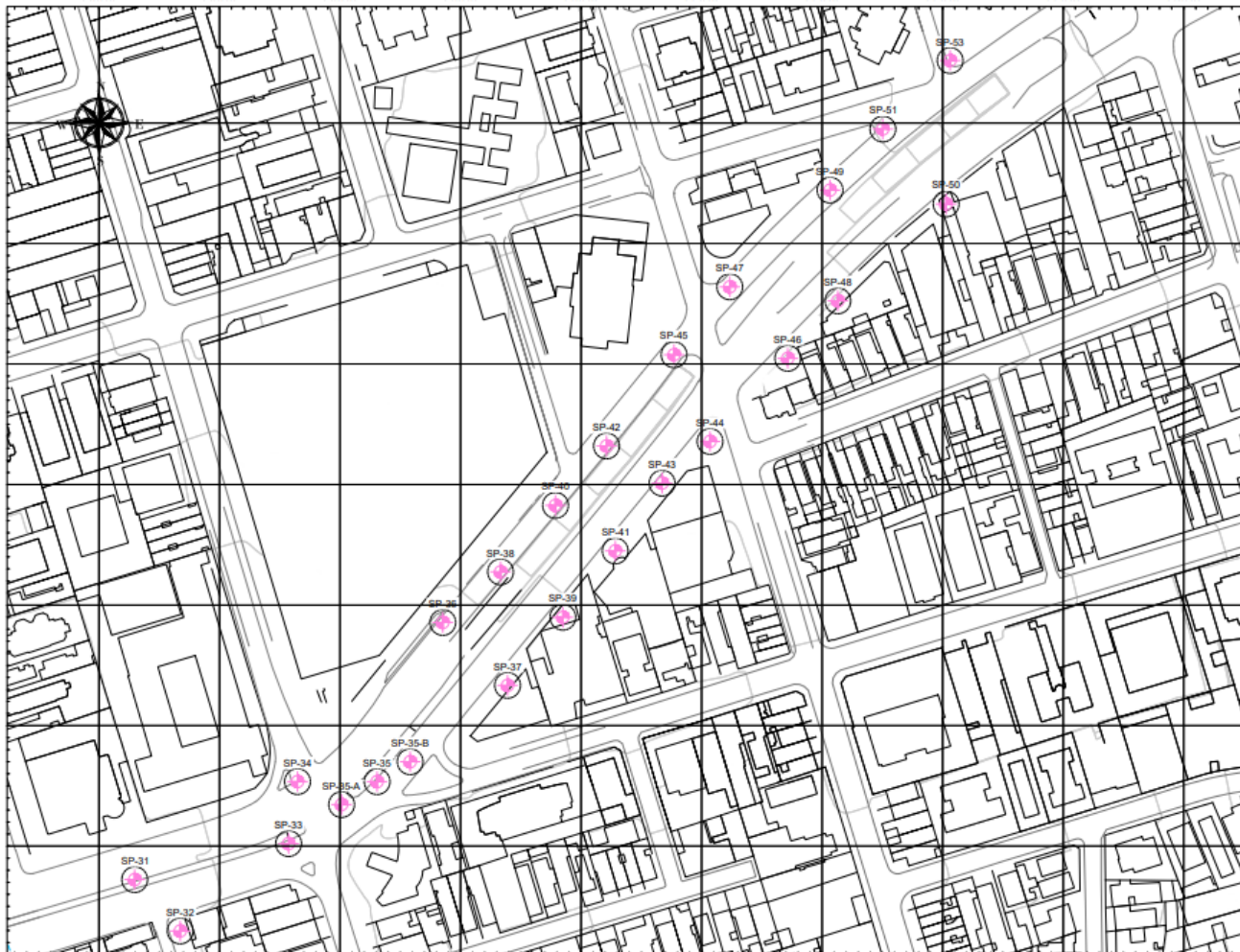
Figura 1 – Mapa de locação dos pontos de sondagem (Fonte: SUM IP, 2023)
